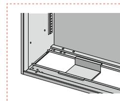
配線ベース内に設置し、床掃除等による水漏れを防ぎます。
