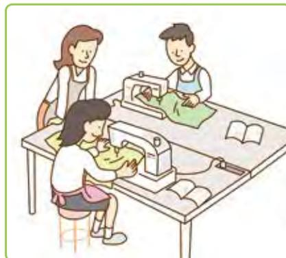
採寸、裁断、仮止め・仮縫い、ミシンがけ、アイロンがけなどの一連の作業により作品を完成させます。試着して、寸法や着心地などを確認します。
