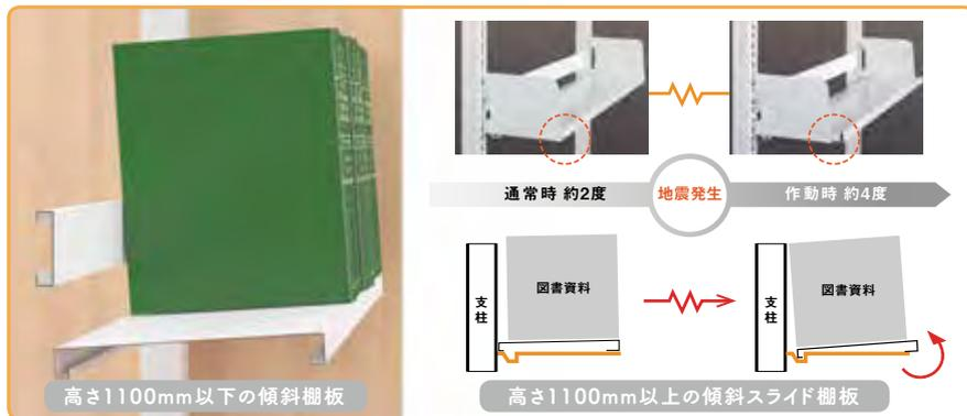
地震に強い全段傾斜棚板です。高さ1100mm以下は傾斜角度が約4度で固定された棚板です。高さ1100mm以上の棚板は、通常時、傾斜角度が約2度になっており、地震時の揺れに応じて傾斜角度が約4度となる構造です。この傾斜角度により本の落下を軽減します。通常使用時の背表紙の見やすさと地震対策を兼ね備えた設計です。
