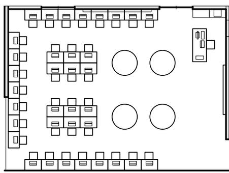
↑ 可動機を採用し、レイアウトが容易に変更できる計画です。高速無線LANを整備し、容易に持ち運ぶことができるモバイル型パソコンや、マウス操作やキーボード入力を覚えなくても指や専用ペンを使って感覚的に操作ができるタブレットPCを使う場合に適しています。
